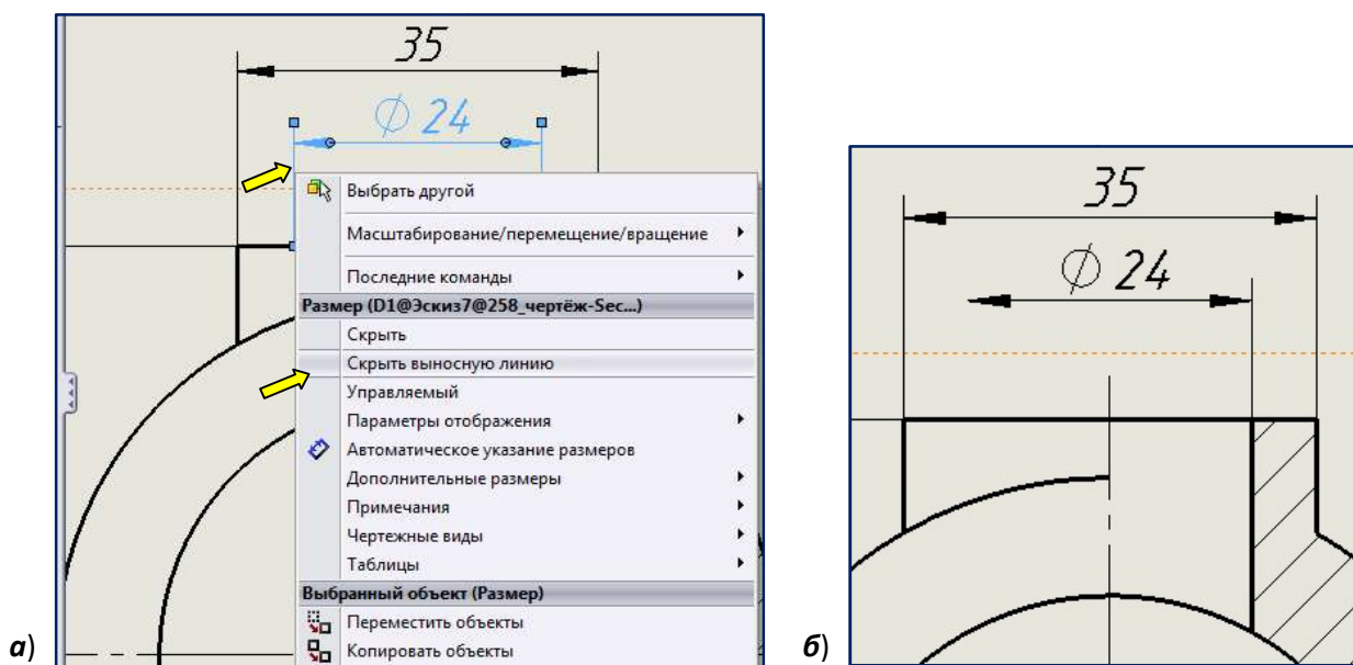
Рис. 3.66. Скрытие выносной линии размера диаметр 24
